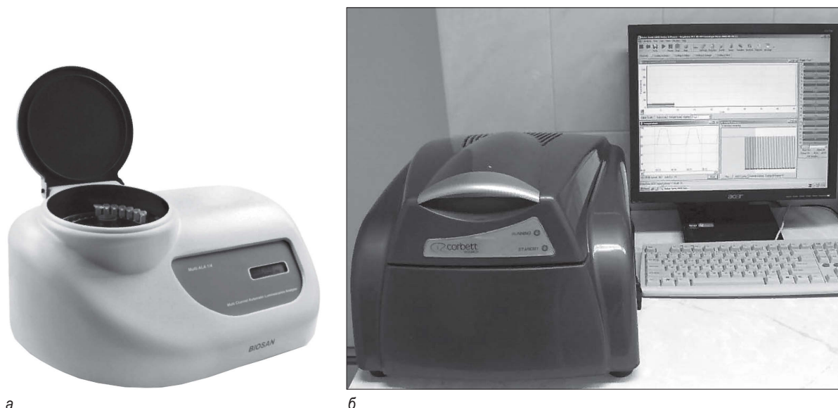
Рис. 7. Флуоресцентный детектор продуктов амплификации (а); оборудование для проведения ПЦР в режиме реального времени (б)
